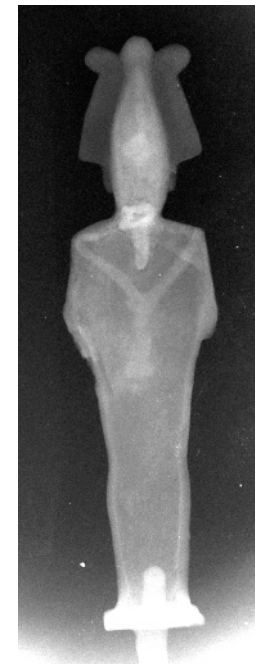
Slika 3: Nevtronska radiografija kipa Ozirisa, ki je zalit s svinčom (Institut Jožefa Stefana, posnetek: Jože Rant, Zoran Milić)
