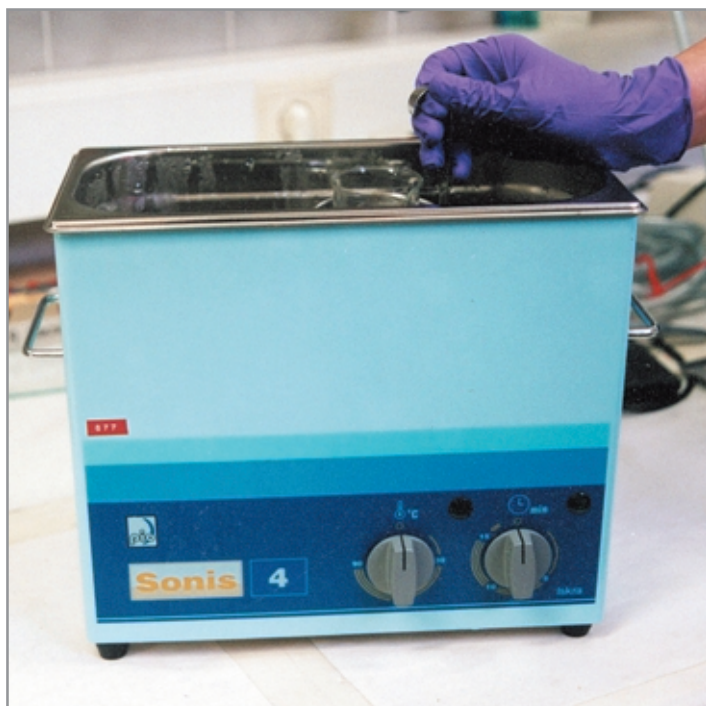
Slika 1: Čiščenje zlata v ultrazvočni kadi
