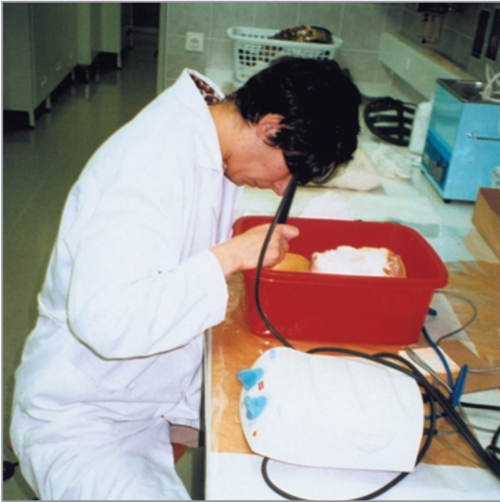
Slika 3: Čiščenje naslag na glavi iz marmorja z mokrim ultrazvočnim kladiščem
