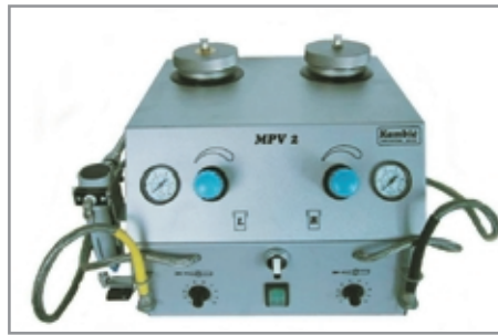
Slika 2: Peskalnik s potiskom peska skozi šobo
