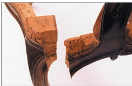
Slika 4b: Poškodovano ogrodje stola zaradi neustrezne uporabe
