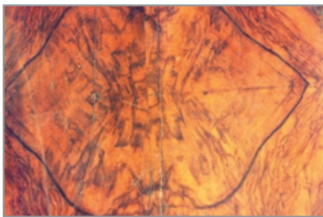
Slika 2: Pokanje furnirja zaradi neprimernih klimatskih razmer med deponiranjem
