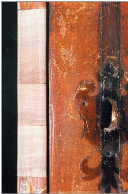
Slika 16: Del novega profila iz jablanovine. Pod ščitom je vidna tudi originalna črna barva furnirja, ki je drugod zaradi vpliva svetlobe zbledela.
