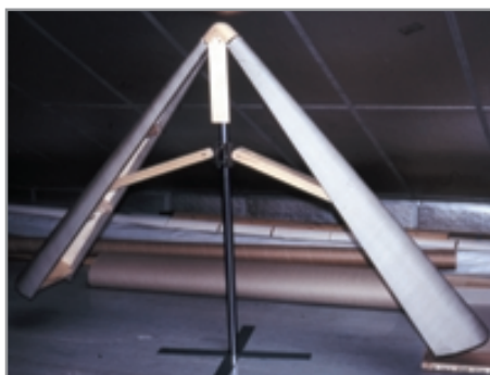
Slika 24: Po meri narejeno stojalo za mašni plašč, z določenim nagibom za ramena, ki ustreza oblačilu in z ustrezno širokimi kraki.
