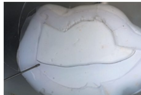
Slika 41: Injektiranje epoksi smole v kalup
