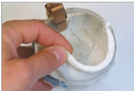
Slika 38: Odstranjevanje notranjega kalupa iz silikonskega kavčuka
