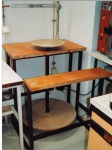
Slika 38: Lončarsko vreteno/stružnica z nosilcem za šablone
