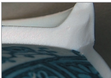
Slika 1: Prelom predmeta iz pravega porcelana
