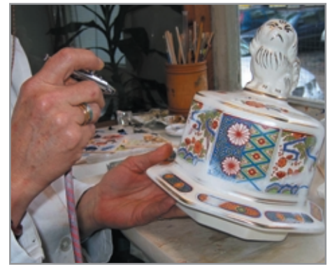
Slika 4: Nanašanje svetle osnove z airbrushem
