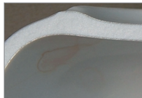
Slika 2: Prelom predmeta iz mehkega porcelana
