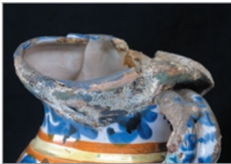
Slika 21: Deformacija dopolnitve zaradi toplote
