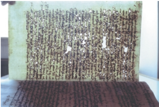
Slika 6: Poškodbe na gradivu so lahko tudi posledica korozivnega delovanja kovinskih ionov, ki jih vsebujejo železotanijska črnila. (Osrednja knjižnica Koper, Cathastico de scrittura de san Niccolo d'Oltre, 1568, Zapis in podoba, str. 46 )
