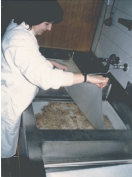
Slika 9: Odstranjevanje vodotopnih nečistoč v vodni kopeli (Župnija Korte, Krstna knjiga 1816–1855, ev. št. 82/97)
