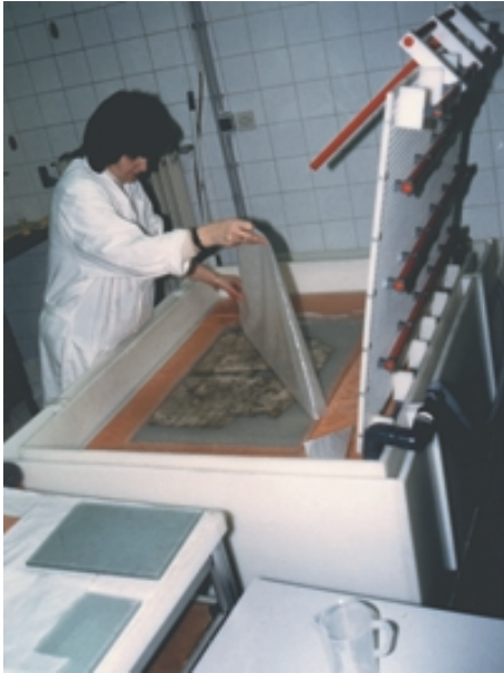
Slika 18: Dopolnjevanje manjkajočih delov s pomočjo stroja za dolivanje s pulpo (Župnija Korte, Status animarum , 2. pol. 19. stol., ev. št. 81/97)
