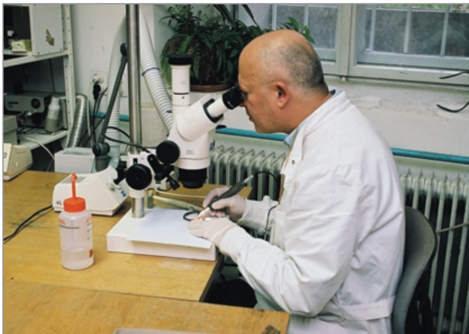
Slika 19: Uporaba binokularne lupe za natančen nadzor čiščenja
