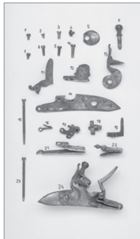
Slika 31: Označeni deli razstavljenega mehanizma pištole
