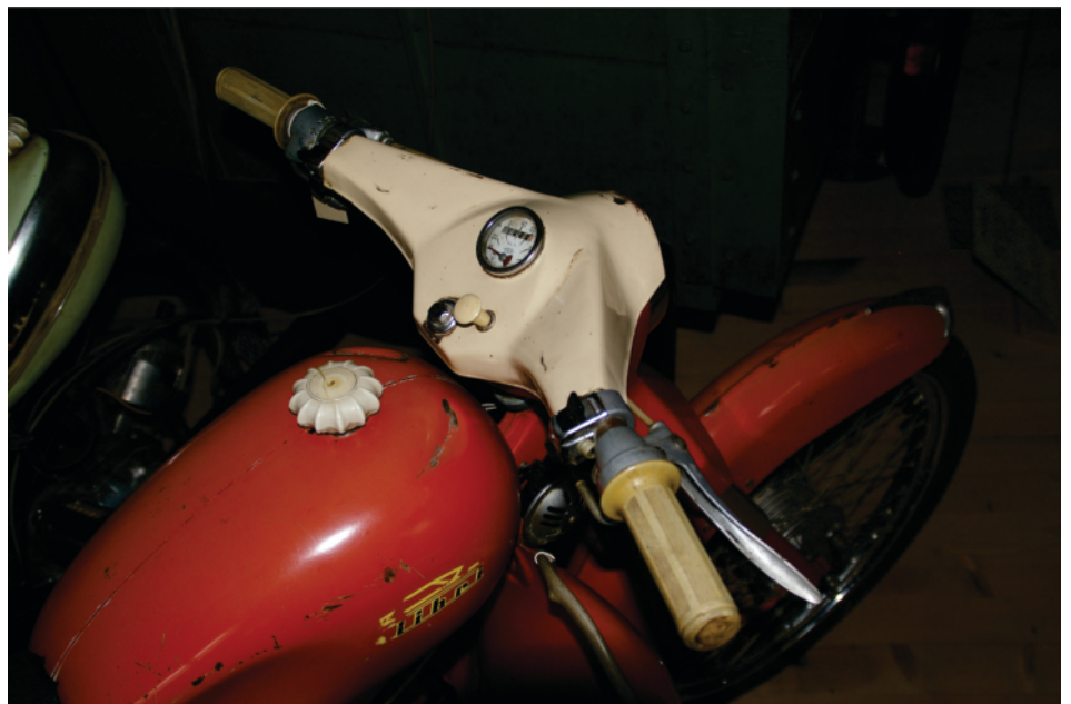
Slika 4: Udrtine na rezervoarju motornega kolesa Tomos T12 (Tehniški muzej Slovenije, inv. S0000442)
