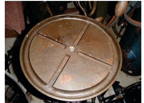
Slika 5: Poškodbe od svedra na mizi vrtalnega stroja
