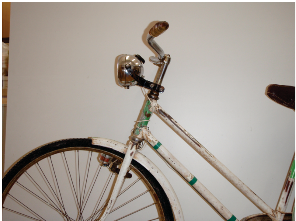
Slika 7: Kolo Valy iz leta 1940 z značilnimi odrgninami laka in jeklenimi platišči
