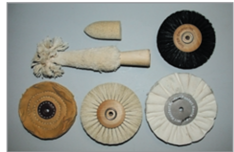
Slika 8: Polirni koloti (bombažni koloti, volneni koloti, usnjeni koloti)
