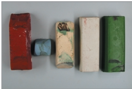
Slika 7: Polirne paste (polirna bela, polirna rumena, polirna zelena, polirna plava, polirna rdeča, pariško rdeča) in polirne pene
