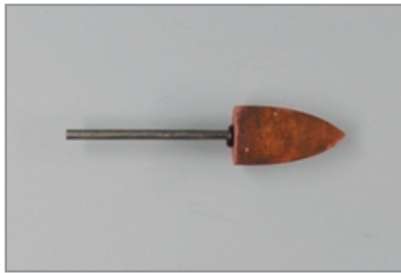
Slika 6: Na sliki vidimo zamazano površino brusnega kamna zaradi pregretja površine pri brušenju.
