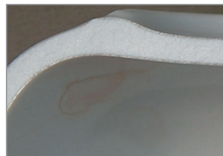
Slika 2: Prelom predmeta iz mehkega porcelana
