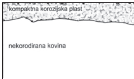
Skica 3: Korozija na suhem
