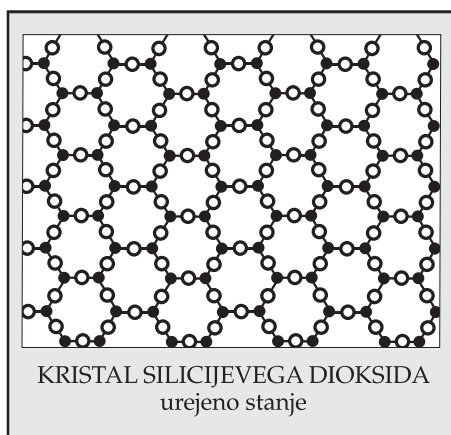
Skica 1: Struktura kristala silicijevega dioksida in staljenega silicijevega stekla
