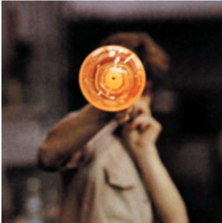
Slika 5: Oblikovanje stekla s steklarsko pipo
